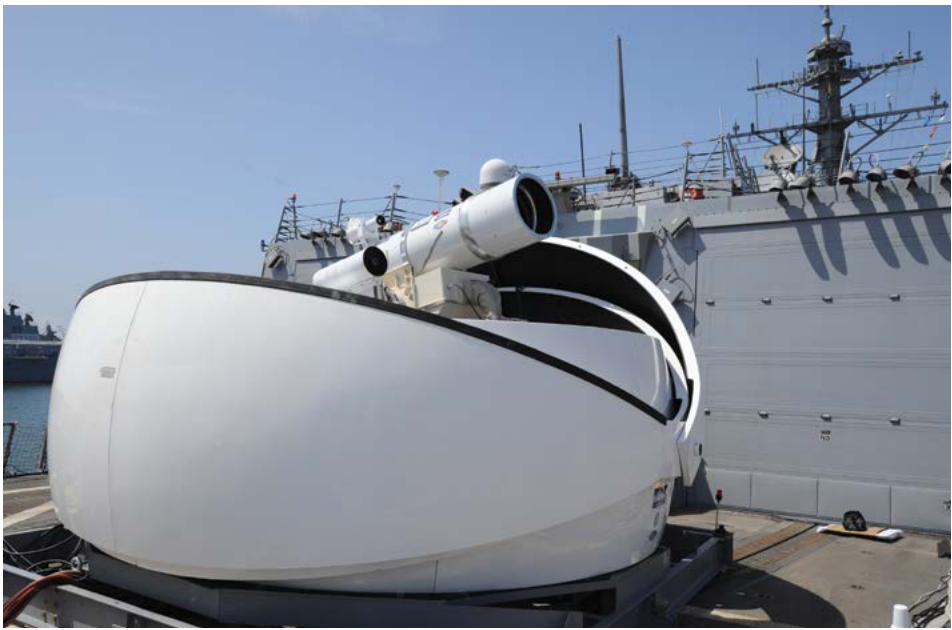
Hình từ Bộ quốc phòng cho thấy Hệ thống Vũ khí Laser (LaWS) được lắp đặt tạm thời trên khu trục hạm với tên lửa dẫn đường USS Dewey (DDG 105) ở San Diego, Calif. Đây là một thử nghiệm công nghệ do Bộ Tham mưu Kỹ thuật Hàng hải của Hải quân Hoa Kỳ chế tạo từ chùm tia laser trạng thái rắn, sử dụng các phương pháp kết hợp được phát triển tại Phòng Thí nghiệm Nghiên cứu Hải quân. Tình năng này cung cấp cho các tàu Hải quân một phương pháp để dễ dàng đánh bại các tàu nhỏ và các mục tiêu trên không mà không cần sử dụng đạn.
