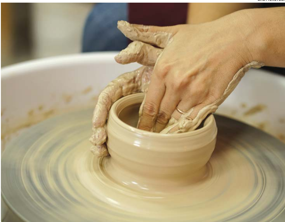
Gốm Bát Tràng được tạo hình thủ công trên bàn xoay.
