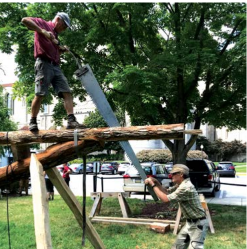
Những thợ mộc sử dụng cưa dọc để cắt gỗ.
