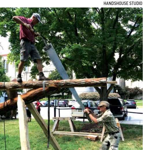
Những thợ mộc sử dụng cửa dọc để cắt gỗ.
