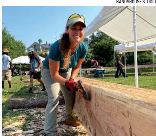
Một người thợ mộc làm phẳng khúc gỗ bằng riu trong một quy trình gọi là “hewing”.
