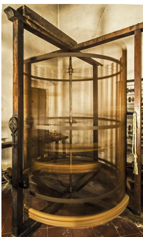
Máy móc sợi dọc.
