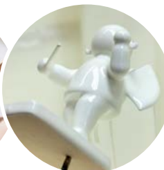
▲ Mỗi bức tượng gỗ nhỏ đã ghép xong được nhúng vào sơn trắng ba lần để tạo một lớp sơn lót.
